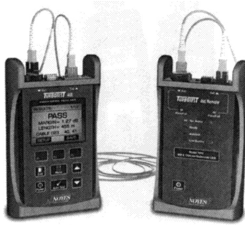
الشكل 5-8 جهاز تيربوتست 400 (Turbotest 400) (تقدمة من نويّس)
